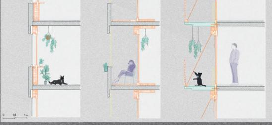
Um den Wärmeverlust zu verringern, ermöglichen unterschiedliche konstruktive Massnahmen eine Varianz an Raumqualitäten.
